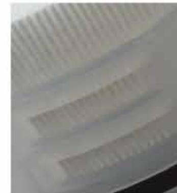
Ein plissiertes Membranfilterelement ist äußerlich kaum von einem plissierten Partikelfilter zu unterscheiden.
