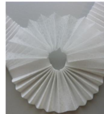
Ein aufgeschnittenes Faltelement zeigt den Aufbau mit den einzelnen Lagen in einem plissierten Filter.
