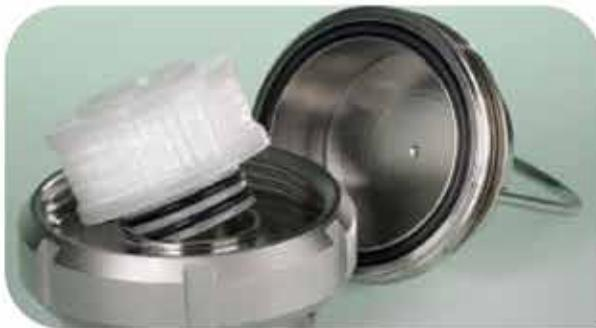
Das totraumoptimierte Laborgehäuse 025adf bietet Platz für eine Filterkerze mit 25mm Länge und wird von unten über einen seitlichen Zulauf beschickt. Mittig wird das Filtrat aus dem Gehäuse geleitet. Das Gehäuse ist für kleine Proben ausgelegt, die z.B. als Qualitätsmuster aus der Produktion ins Labor kommen und zur Endfreigabe geprüft werden müssen.
